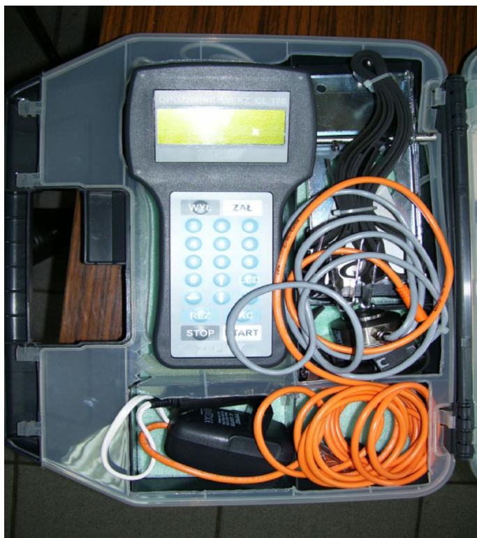
Rys. 3.23. Opóźnieniomierz CL-170 firmy ZEPWN
