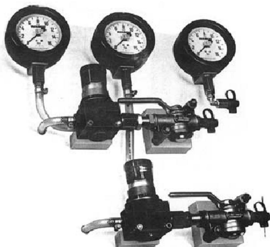
Rys. 3.7. Urządzenie Wabco 435 008 do kontroli automatycznych regulatorów siły hamowania sterowanych od zawieszenia powietrznego [13]
