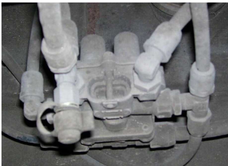
Rys. 1.15. Widok ogólny czteroobwodowego zaworu zabezpieczającego
