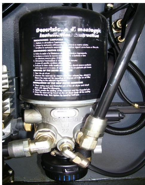
Rys. 1.12. Osuszacz powietrza z regulatorem ciśnienia: a) widok ogólny, b) schemat budowy [2]:
