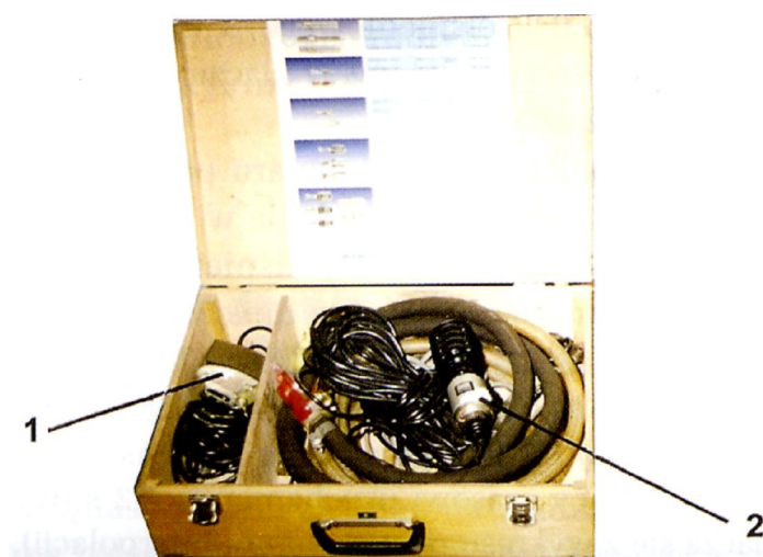
Rys. 3.10. Wyposażenie przyrządu do badania czasu reakcji hamulców firmy Wabco [12]
