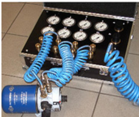
Rys. 3.6. Walizkowy zestaw kontrolno-pomiarowy PneuMAR [21]
