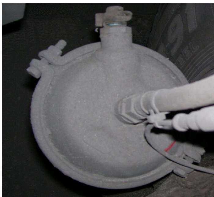
Rys. 1.36. Widok siłownika membranowego od strony króćca zasilającego
