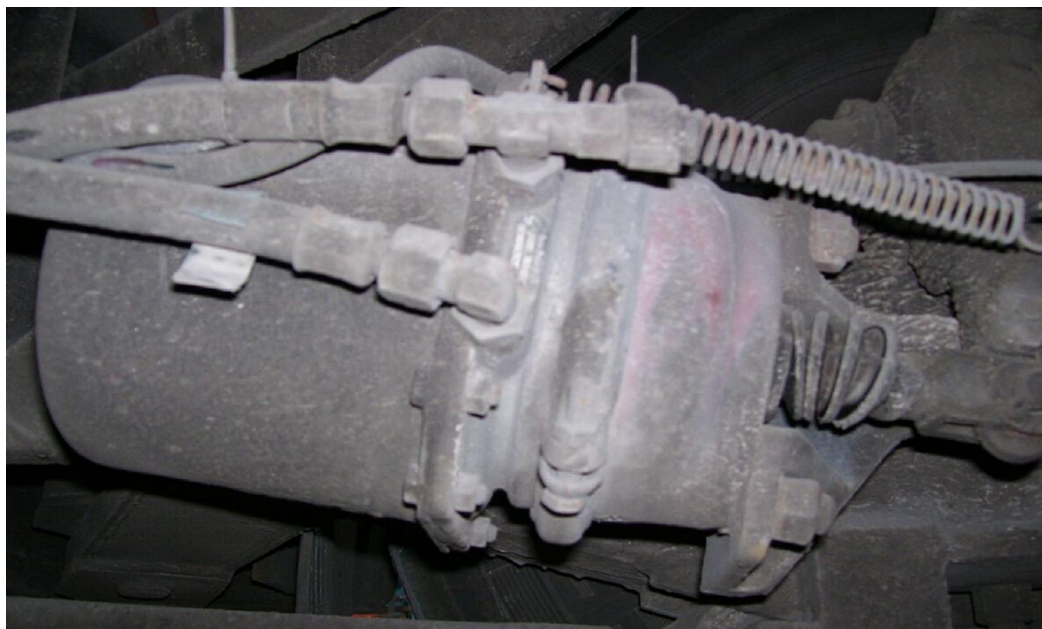
Rys. 1.38. Widok siłownika membranowo-sprężynowego.
