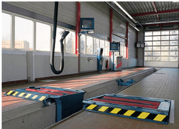
Rys. 3.20. Uniwersalne stanowisko rolkowe IW7 Screen firmy MAHA [20]
