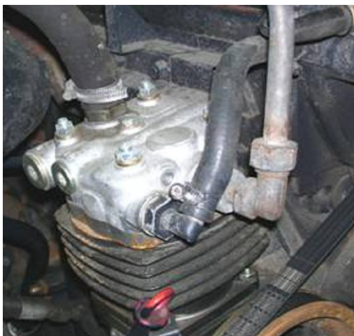
Rys. 1.4. Sprężarka powietrza typ HS 21.4: a) widok ogólny, b) schemat budowy [2]: 1 - korpus sprężarki, 2 - koło zębate napędzające, 3 - kołnierz łączący, 4 - sprzęgło napędu pompy wtryskowej, 5 i 5.8 - króćce, 6 - podkładka, 7 - króciec, 8 - głowica cylindrów z zaworami.
