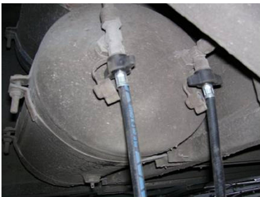
Rys. 1.6. Widok zbiornika powietrza o pojemności 30 dm 3
